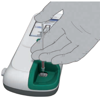
150 µL heparinisiertes venöses Vollblut aufbringen
